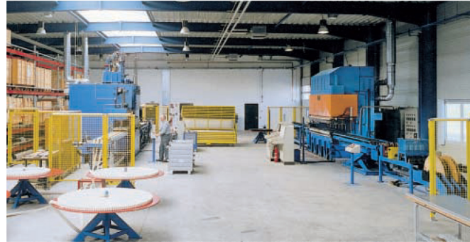
Instalaciones de vulcanizado para la producción de las cadenas de bloques de goma NERAK
